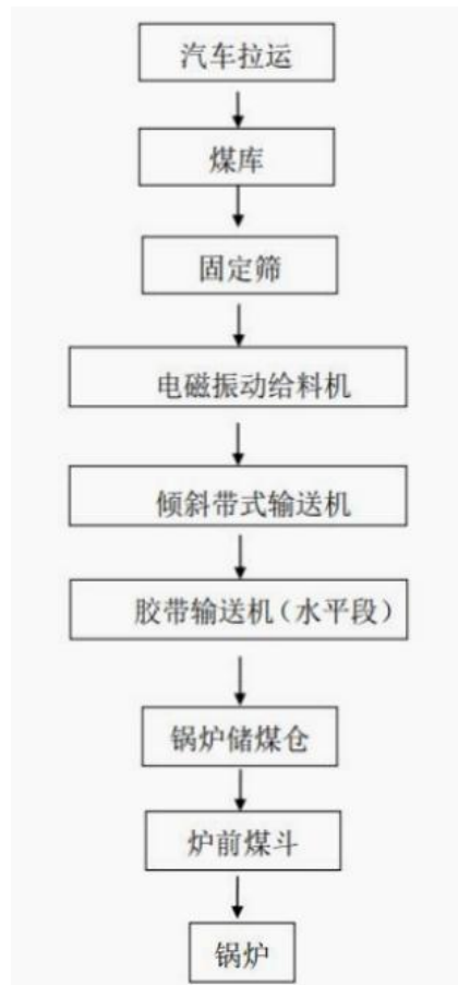
图 3.8-2 上煤系统工艺流程图
